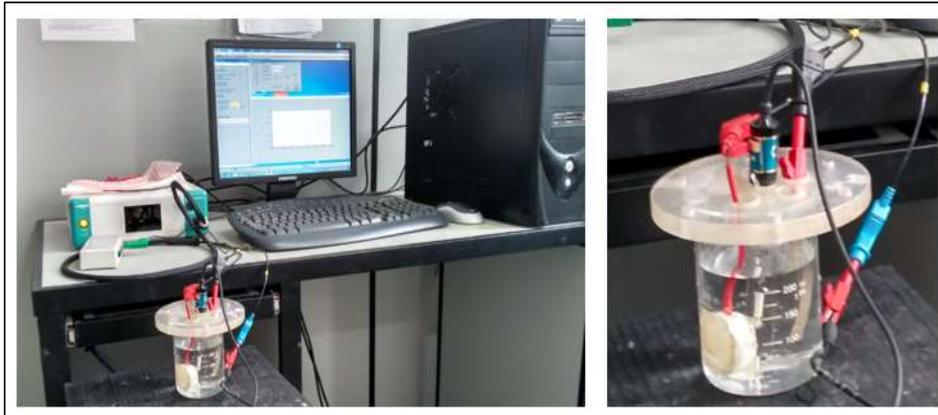
Figura 14: potenciostato e a célula eletroquímica
