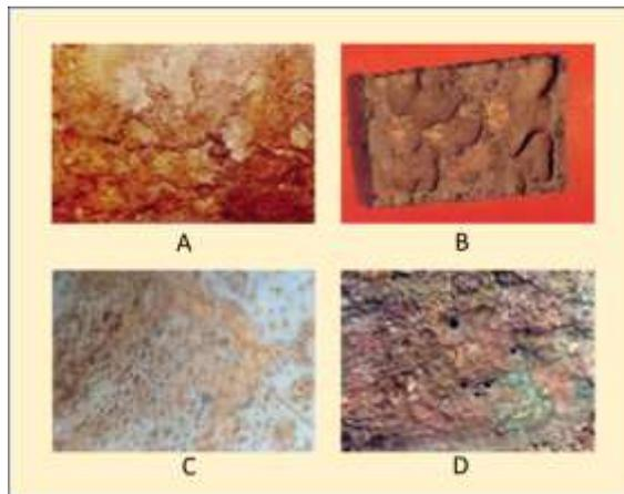
Figura 3: Corrosão generalizada - A, Corrosão por placas - B , Corrosão Alveolar - C, Corrosão por Pites -Gentil 2011
