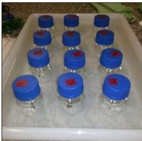
Figura 13: Sistema utilizado para o ensaio gravimétrico em solução salina
