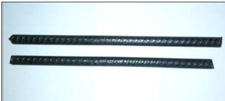
Figura 3.8 – Barras de aço utilizadas nos experimento após limpeza
