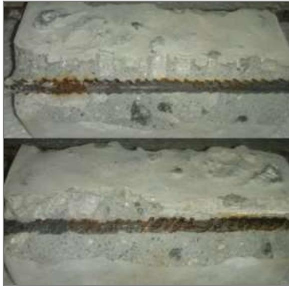
Figura 4.24 - Corpo de prova de concreto sem inibidor de corrosão nas barras de aço carbono onde são observados pontos de corrosão
