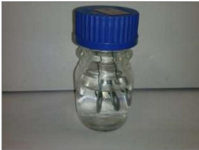
Figura 3.3 - Sistema utilizado para o ensaio gravimétrico em solução salina não aerada
