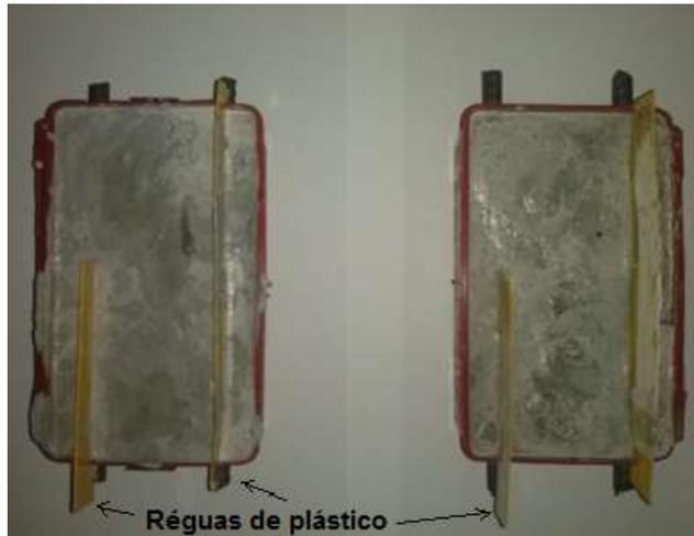
Figura 3.11 - Sistema de forma utilizado na moldagem dos corpos de prova de concreto armado com a régua de plástico que visa simular uma fissura contínua.
