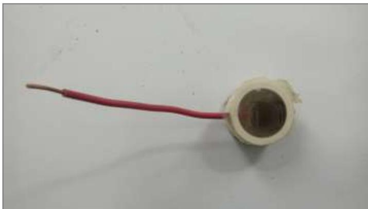
Figura 3.6 – Eletrodo de trabalho utilizado nos ensaios eletroquímicos
