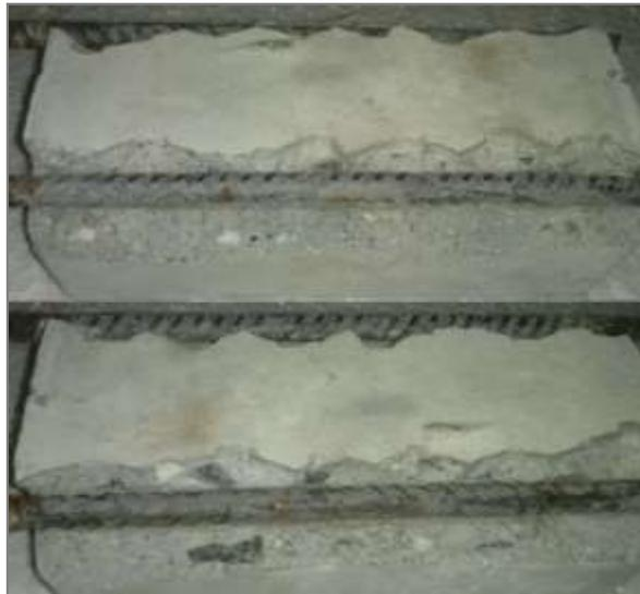
Figura 4.25 - Corpo de prova de concreto com inibidor de corrosão nas barras de aço carbono onde não foram observados pontos de corrosão
