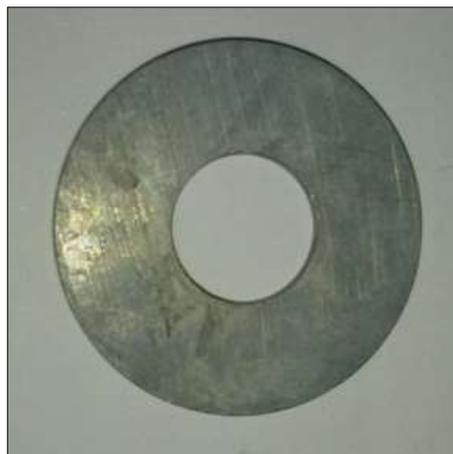
Figura 3.1 - Corpo de prova de aço carbono 1020
