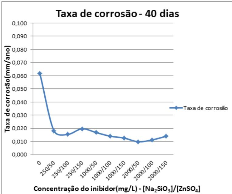
Figura 4.11- Taxa de corrosão do aço carbono na presença e ausência do inibidor de corrosão, em solução não aerada de NaCl 3,5% para o tempo de imersão de 40 dias.
