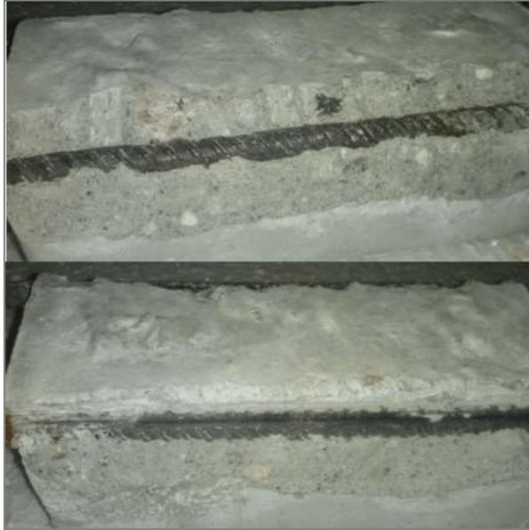
Figura 4.26 - Corpo de prova com aditivo inibidor incorporado na massa de concreto onde não foram observados pontos de corrosão na barra de aço carbono
