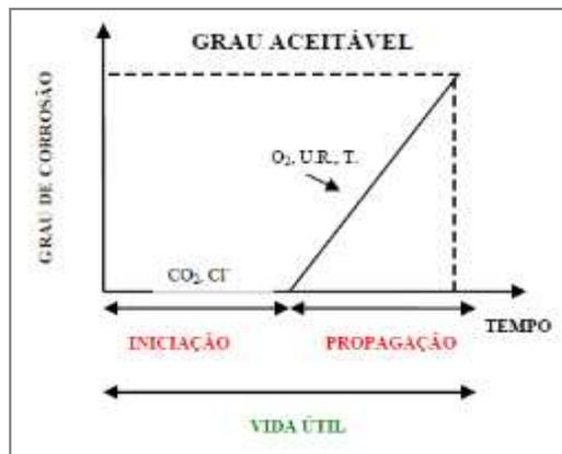
Figura 2.12 - Representação esquemática do modelo de vida útil
