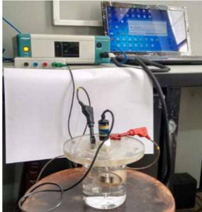
Figura 23 - Potenciostato e a célula eletroquímica
