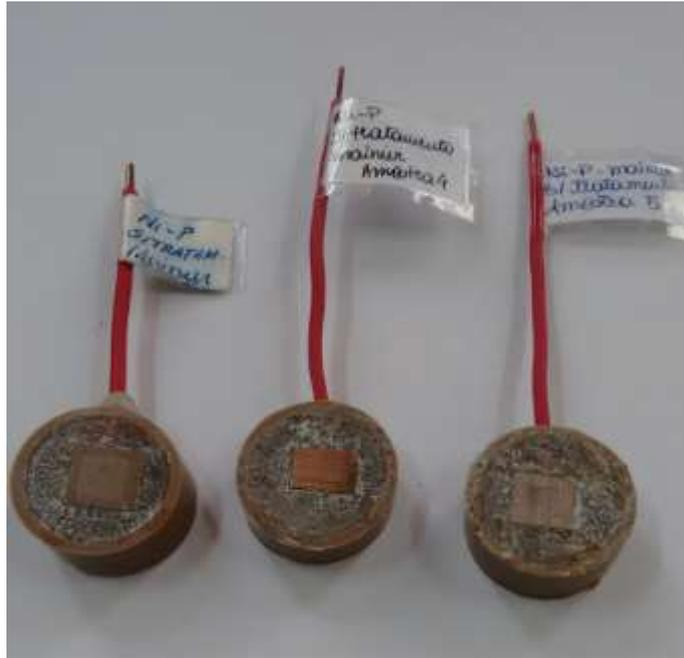
Figura 25 – Eletrodos de trabalho utilizados nos ensaios eletroquímicos.
