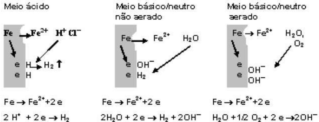
Figura 5 – Mecanismo de corrosão eletroquímica (MAINIER, 2007)
