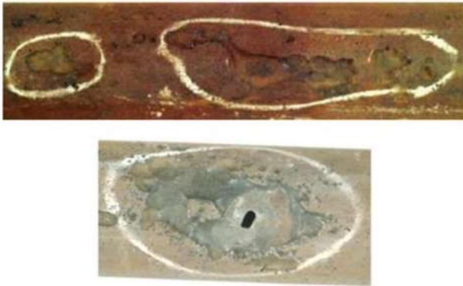
Figura 19 - Corrosão por injeção de ácido clorídrico em tubos de aço-carbono (MAINIER, 2010).
