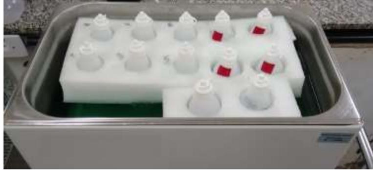
Figura 22 - Sistema utilizado para o ensaio gravimétrico em solução ácida
