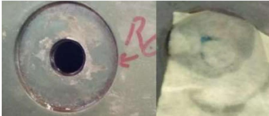
Figura 16 - Teste ferroxyl aplicado para determinar a porosidade de camada Ni-P sobre aço-carbono
