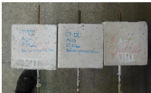
Figura 4-9: Corpos de prova de concreto e barras de aço, CP-A1, CP-A2 e CP-A3.
