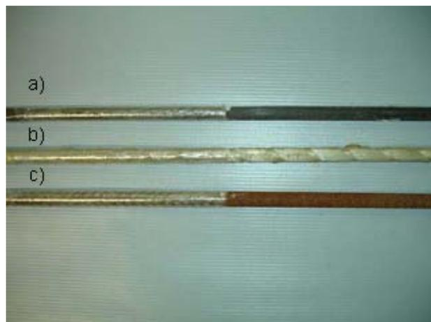
Figura 4-7: Detalhe do cobrimento com capa de plástico de parte do comprimento da barra, para a zona aderente e zona não aderente: a) CFRP; b) GFRP e c) aço.
