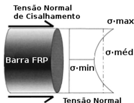
Figura 3-10: Distribuição normal de tensões em uma barra FRP submetida à tração axial. Fonte: ACHILLIDES e PILAKOUTAS (2004).
