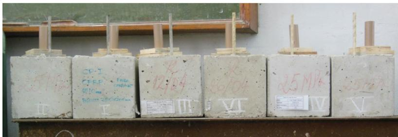
Figura 4-10: Corpos de prova de concreto e barras de fibras de carbono e barras de fibras de vidro, CP-C1, CP-C2, CP-C3, CP-V1, CP-V2 e CP-V3.
