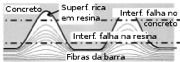
Figura 3-11: Interfaces de ruptura na superfície da barra FRP. Fonte: ACHILLIDES e PILAKOUTAS (2004).
