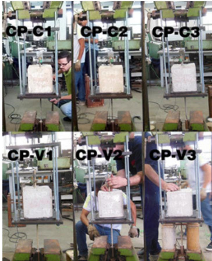
Figura 4-17: Execução dos ensaios dos corpos de prova de concreto e barras de fibras de carbono e fibras de vidro.
