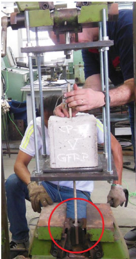
Figura 4-16: Detalhe da garra da máquina de tração e a luva de proteção da barra de GFRP.
